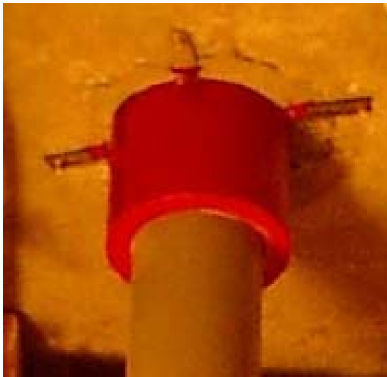
Фото 2. Вид внутри огневой камеры универсального стенда до начала теплового воздействия на муфту (манжету)
