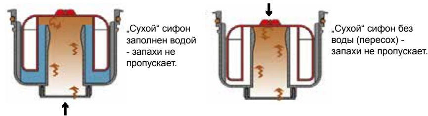
Принцип действия „СУХОГО“ сифона
