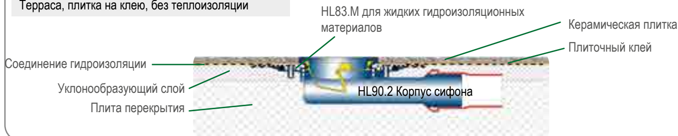
Терраса, плитка на клею, без теплоизоляции
