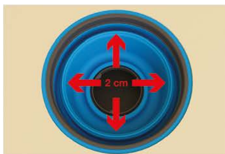
11. Гибкая мембрана даёт возможность перемещения уплотнительного кольца в пределах 4 см (плюс-минус 2 см от центра)
