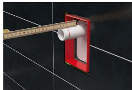
6. Отметить на резьбовой патрубке расстояние 3 см, измеряется от поверхности стены (плитки)
